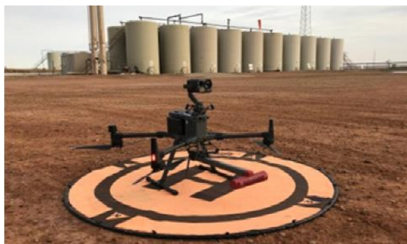
图5 甲烷探测无人机 56
